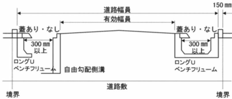
2 道路側溝にU型側溝又は自由勾配側溝とL型側溝を併用する場合
