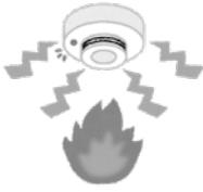
住宅用火災警報器は、基本的には寝室と寝室がある階の階段上部（1階の階段は除く）に設置することが必要です。また、住宅の階数などによっては、その他
