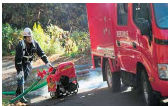
可搬ポンプの操作
