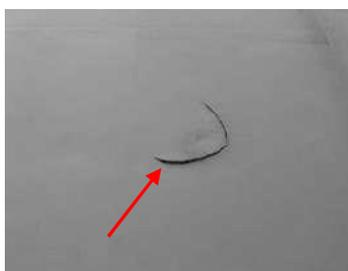
●防水層の破断、損傷\*2
