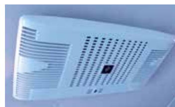
町営バス天井に設置された 空気清浄機
