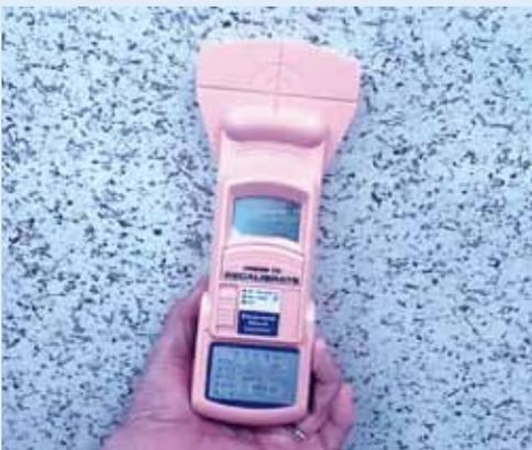
ブロック塀の鉄筋の有無がわかる探査機
