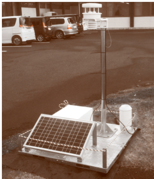
設置される小型雨量計
